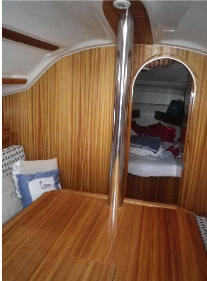
**Epontille:** Poutre placée sous le mât pour renforcer la tenue du pont, et reporter la compression du pied de mât vers la quille.
